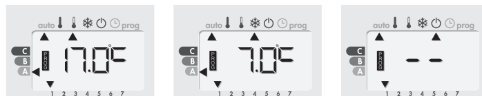
Fil pilote = Éco - 2 Confort - 2°C
