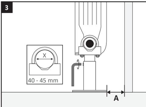
A = Distance pieds / mur : 30mm pour les radiateurs électriques bas Néomitis et standard, 40mm pour les radiateurs électriques slim Néomitis.
