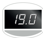
Fil pilote = Éco - 2 Confort - 2°C
